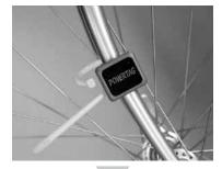
2) フロントホークに装 着し、タイラップの 細い先端を穴に通 して強く引きます。
